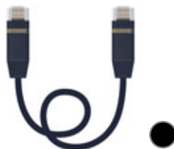
Kabel k počítači označený černým kolečkem (konektory RJ-45)
